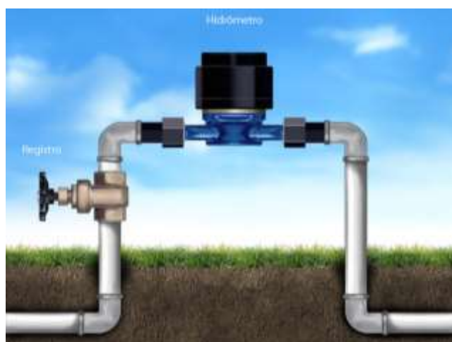
Figura 49 – Ilustração da ligação domiciliar composta por registro, hidrômetro e cavalete.
